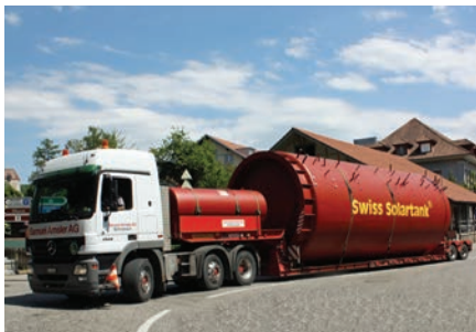
Solarspeicher Swiss Solartank® bis 200'000 l, auch platzgeschweisst, kombinierbar mit verschiedenen Wärmequellen
