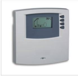
Die Ofensteuerung WAL03 wird **im Wohnraum** in der Nähe des Walltherm® -Ofens montiert. Die Regelung WAL03 gibt nicht nur Temperaturinformationen zur Anlage, sondern regelt auch die el. Verbrennungsluftklappe (falls vorgesehen) diese muss vor jedem Anheizen per Knopfdruck (Taste rechts oben) geöffnet werden, daher muss die Regelung in der Nähe des Ofens sein!
