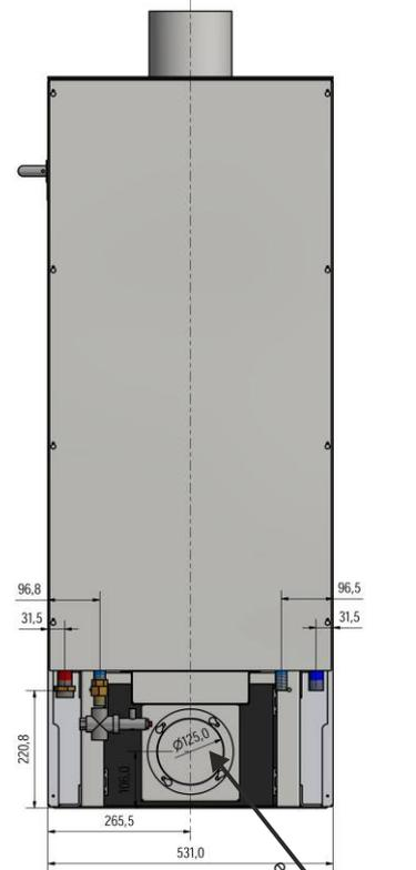
**Hinweis:** Damit die Tür geöffnet werden kann ist es wichtig, dass der Ofen auf die Ebene des fertigen Fußbodens gebracht wird.
