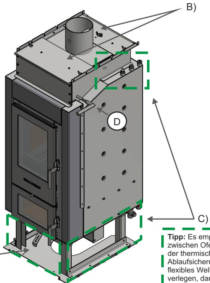
**Tipp:** Es empfiehlt sich zwischen Ofen und der thermischen Ablaufsicherung ein flexibles Wellrohr zu verlegen, dann kann die Wartung auch von der Seite erfolgen.
