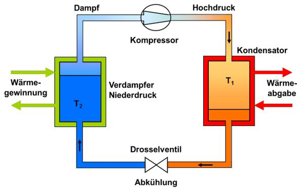
Die Wärmepumpe ist eine Carnot-Maschine, d.h. ihr Wirkungsgrad ist abhängig von der Verdampfungstemperatur und der Kondensationstemperatur des Kältemittels. Je geringer die Differenz zwischen Kondensations- und Verdampfungstemperatur, desto besser ist die Leistungsziffer. Demzufolge sollte die Wärmepumpe auf der Kondensatorseite mit möglichst tiefen Temperaturen betrieben werden, was beim Heizbetrieb, nicht jedoch bei der Warmwasseraufbereitung gewährleistet ist.
