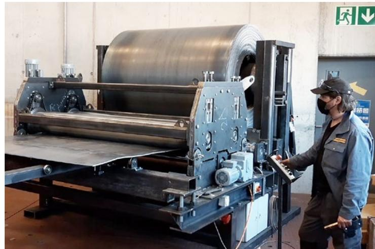
Abcoilanlage für Stahlbleche von 10 bis 15 mm. Diese Investition realisierten wir dank einer finanziellen Unterstützung des Kantons Bern an die Lohnkosten im Corona-Jahr 2020.
