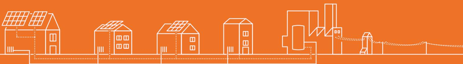
Weiter kann das Netz entlastet werden, indem der Strom direkt im Ortsnetz verwendet wird. Zum Beispiel in einer Fernwärmezentrale, die gezielt Überschüsse nutzen kann, um den (Holz) Energiebedarf zu reduzieren. So können auch an der Fernwärme angeschlossene Liegenschaften von der Sonnenenergie profitieren.
