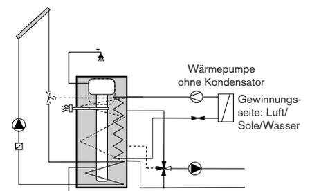
Standard-Speicher mit integriertem Kältemittel-Tauscher steigert die Leistungsziffer der Wärmepumpe.
