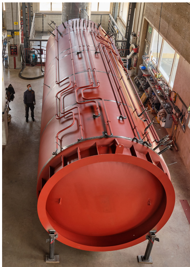
Der Seicher ist ohne Isolation 11.8 Meter hoch und hat einen Durchmesser von 3.4 Meter.
