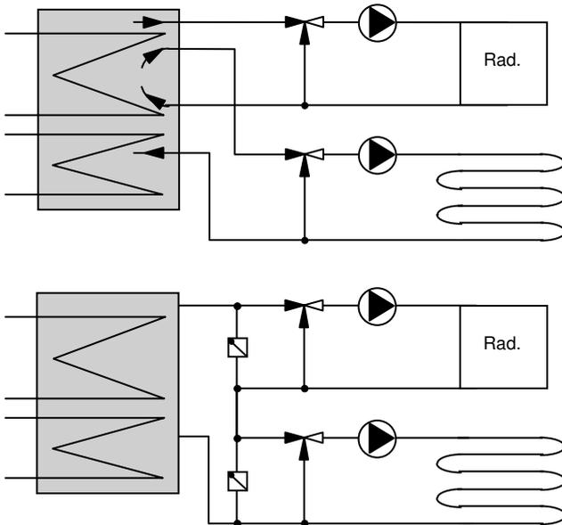
1. Die Gruppen werden mit eigenen Anschlüssen an den Speicher angeschlossen. Durch geschickte Wahl der Höhe kann eine prinzipielle Serieschaltung erreicht werden.
