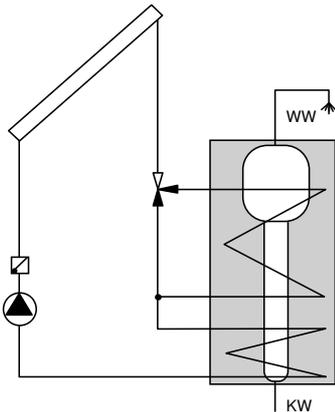
Bei Anlagen für Heizung und Warmwasser werden meistens Speicher mit integriertem Boiler eingesetzt. Dadurch können einfache, gut arbeitende Anlagen ohne viele bewegliche Teile und ohne grossen Steuerungsaufwand usw. realisiert werden.
