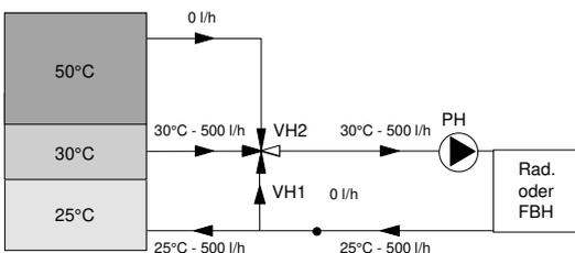
Wird mit einem weiteren Ventil (VH2) die Möglichkeit geschaffen, Wasser aus dem mittleren Speicherteil zu beziehen (nur solar geheizt), fließt die ganze Wassermenge, die in der Heizung umgewälzt wird, in den Speicher zurück. Das Wasser wird so im unteren Bereich schneller kühl. Den Sonnenkollektoren steht mehr kaltes Wasser zur Verfügung und der Speicher bleibt oben länger warm.
