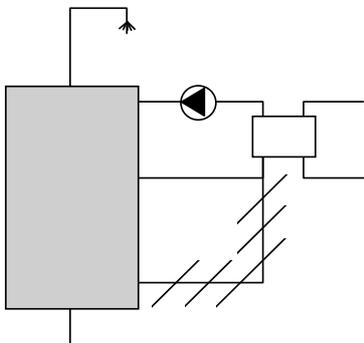
Wird der Boiler über einen externen Tauscher nachgeladen, sollte dies mit nicht zu grosser Wassermenge geschehen. Die Anschlüsse müssen richtig platziert und so konstruiert sein, dass das ein- und austretende Wasser keine Wirbel erzeugt. Diese würden die Schichtung zerstören. Ist der Boiler fertig geladen, muss die Umwälzpumpe ausgeschaltet werden.
