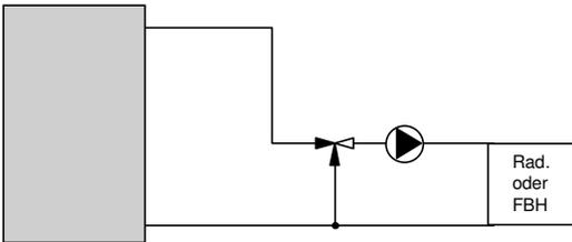
Üblicherweise wird der Vorlauf für die Heizung aus dem oberen Speicherbereich (Bereich der Nachheizung) entnommen und mittels eines Mischventils (Rücklaufbeimischung) auf die erforderliche, relativ tiefe Temperatur heruntergemischt.
