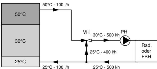
Temperatur im Speicher oben 50°C (von Zusatzenergie), in der Mitte 30°C (von der Sonne) und unten 25°C (vom Rücklauf der Heizung).
