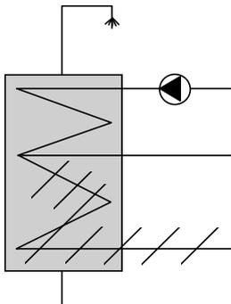
Wird der Boiler ganz zuunterst z. B. mit einem Elektroeinsatz nachgeheizt, nimmt man den Kollektoren ganz offensichtlich das kalte Wasser weg. Analog verhält es sich mit anderen Nachlademethoden.
