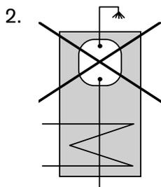
Wenn sich der Boiler nur im oberen Speicherbereich befindet, kann der Speicher nicht geschichtet entladen werden. Die Speicherkapazität wird dadurch sehr schlecht ausgenützt.
