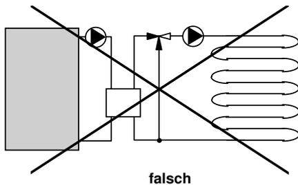
Wegen einer nicht diffusionsdichten Fussboden- oder Wandheizung wird ein externer Wärmetauscher als Systemtrennung eingesetzt. Die Vorlauftemperaturmischung muss auf der Primärseite des Wärmetauschers erfolgen, damit die Primärpumpe nicht laufend den Speicher durchmischt - Solarertrag und Speichernutzen nicht drastisch reduziert werden.
