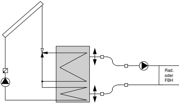
Ideal wäre es, wenn der Vorlauf der Heizung genau aus der Speicherschicht entnommen werden könnte, die der notwendigen Vorlauf-temperatur entspricht (z. B. mit einer Art «teleskopierbarem» Anschluss).
