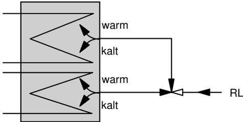
Wenn die Rücklaufstemperatur grösseren Schwankungen unterliegt, kann als weitere Massnahme mit einem externen Ventil der Rücklauf umgeschaltet werden («entweder/oder»). Wichtig ist, dass die Rücklaufstutzen auf der richtigen Höhe angebracht werden.
