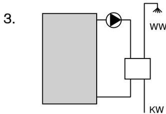
Sehr anspruchsvoll ist die Aufbereitung von Warmwasser mit einem externen Wärmetauscher. Läuft die Pumpe zu viel, wird der ganze Speicher homogenisiert. Läuft sie zu wenig, ist nicht genug Warmwasser verfügbar.
