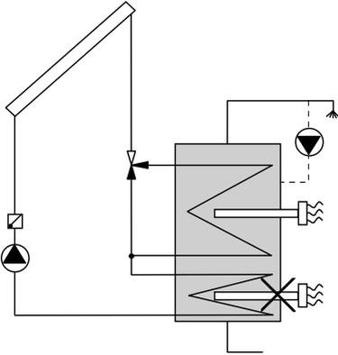
Als Erstes ist wichtig, dass beim Verbrauch das kalte Leitungswasser unten in den Speicher (Boiler) fliesst und das warme oben entnommen wird. Beide Anschlüsse müssen so gestaltet sein, dass keine Wirbel entstehen.
