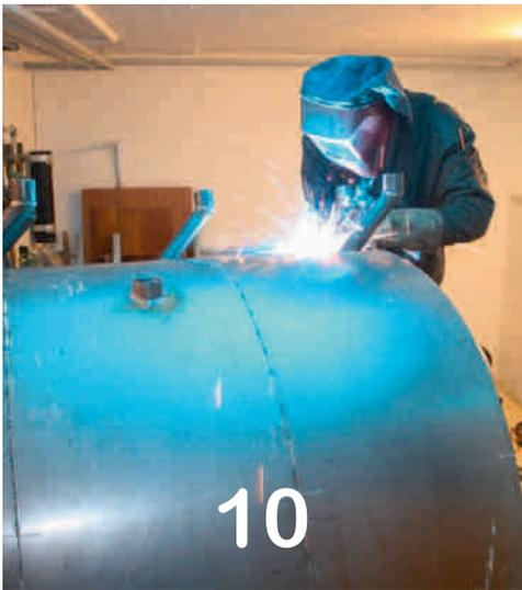
**10** Sind alle gewünschten Komponenten im Speicher installiert, wird der Speicher zusammengesetzt. Die bis jetzt nur aneinander gehefteten Mantelstücke werden mit einer automatischen Rundschweißmaschine final zusammengeschweißt.
