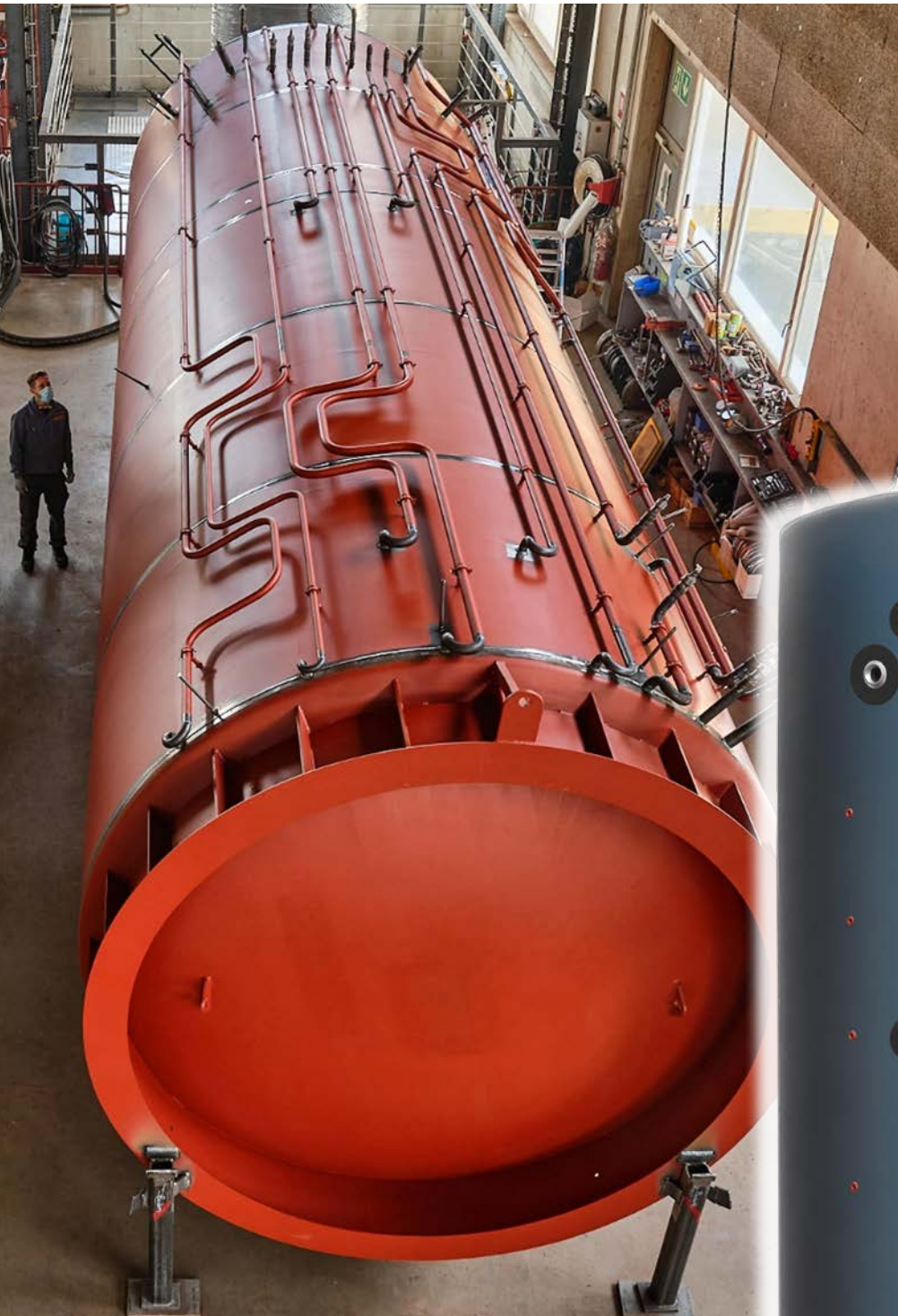
Saison-Speicher mit 98,6 m 3 Inhalt für MFH Ursprung in Benzenschwil AG. Durchmesser Ø 3.40 m, Höhe: 11.45 m.
