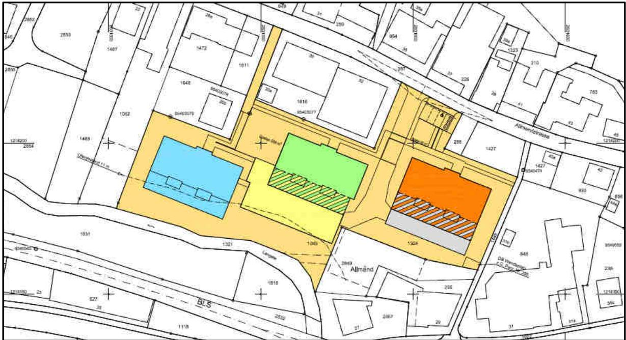
Das blau gefärbte Sonnenhaus ist bereits realisiert. Zu einem späteren Zeitpunkt können ein bis zwei weitere Mehrfamilienhäuser realisiert werden (grün und orange). Gelb eingezeichnet ist die bereits erbaute Einstellhalle.
