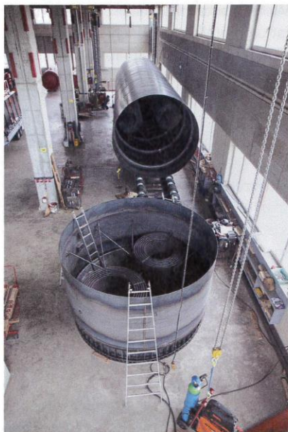
Der etwa 200 Kubikmeter fassende Solarspeicher für das „Solardomizil“ in der Fertigung in der Schweiz.
