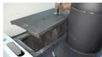
Nachdem der Deckel entfernt wurde, werden die einzelnen Rauchzüge mit der Stahlbürste gereinigt. Die Bürste muss bis zum Boden des unteren Brennraums gedrückt werden. Wenn man die Flammwand aus dem unteren Brennraum entnimmt, sieht man den Bürstenkopf, wenn die Bürste komplett durch die Rauchzüge gestoßen wurde.
