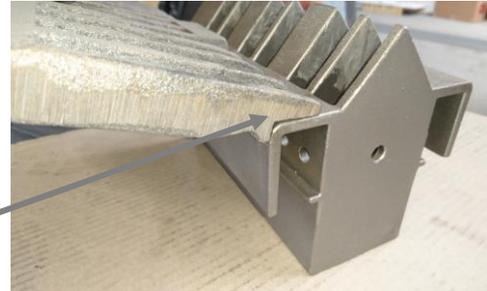
**Achtung:** Die Roste müssen dicht am Injektorblock aufliegen, ansonsten wird der Abbrand sehr stark beeinträchtigt. Bei Verschleiß die Roste dringend wechseln.
