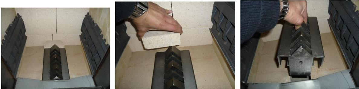
Beim Einlegen des Injektorblocks muss darauf geachtet werden, dass das mittige Loch nach vorne zur Brennraumtür zeigt. (siehe Bild oben)
