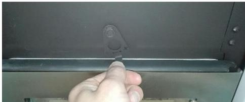
Tipp: Um die volle Nennleistung zu erreichen muss die Sekundärluft komplett geöffnet sein.
