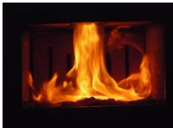
bei der eine zweite Flamme unter der ersten bei sehr hoher Temperatur klar brennt. Dabei verbrennen, bei Zufuhr von Sekundärluft die unverbrannten Gase fast gänzlich, wodurch auch die Heizleistung wesentlich verbessert wird: die schädlichen, durch die unvollständige Verbrennung bedingten  $\text{CO}$ -Emissionen (Kohlenmonoxyd) werden auf ein Minimum reduziert. Es handelt sich hierbei um ein exklusives Merkmal des Walltherm® – Kaminofens.
