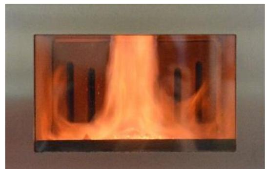
**Info:** Falls die Holzvergaserflamme nach kurzer Zeit (ca. 5 Minuten) abbricht, muss die Anheizklappe erneut geöffnet werden. Eventuell muss das Kaminsystem weiter erhitzt werden, mehr Glut erzeugt werden oder einfach nur das Holz eingerichtet werden (Hohlräume vermeiden).
