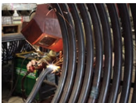
Währenddessen werden im oberen Stockwerk passende Wärmetauscher hergestellt.
