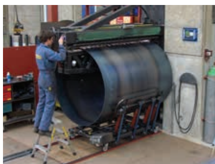
Die Längsschweissnaht wird automatisch ausgeführt.
