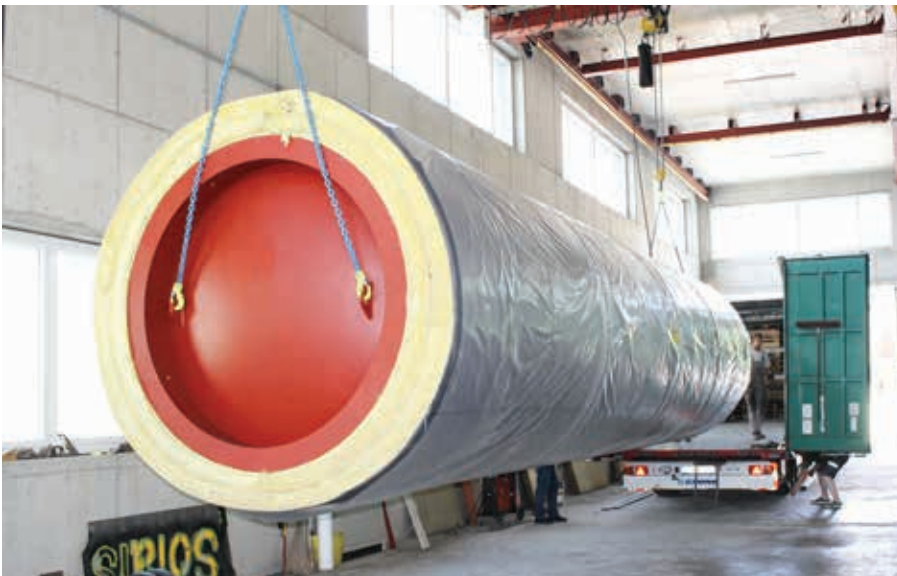
Glaswolle oder Schaumstoff (Brandklasse III oder V) mit Kunststoffhülle Auf Wunsch: Werkisolation mit Wetterschutzfolie
