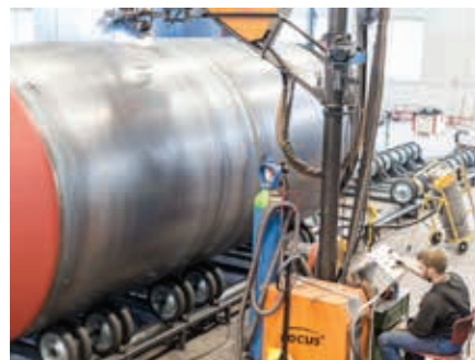
Zusammenschweissen der Mantelteile und aufsetzen von Speicherdeckel und -Boden.
