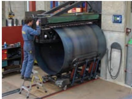
Die Längsschweißnaht wird automatisch ausgeführt.
