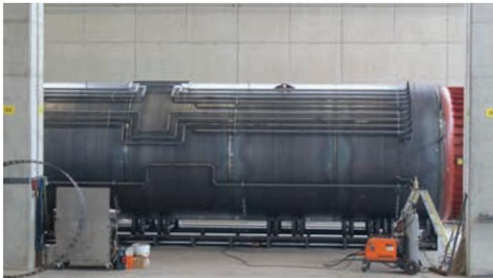
In Arbeit: Solarspeicher mit **angeschweisster Verrohrung**
