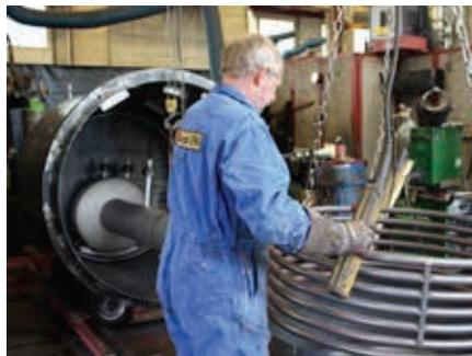
Wärmetauscher, Boiler und Stützen werden angeschweisst.
