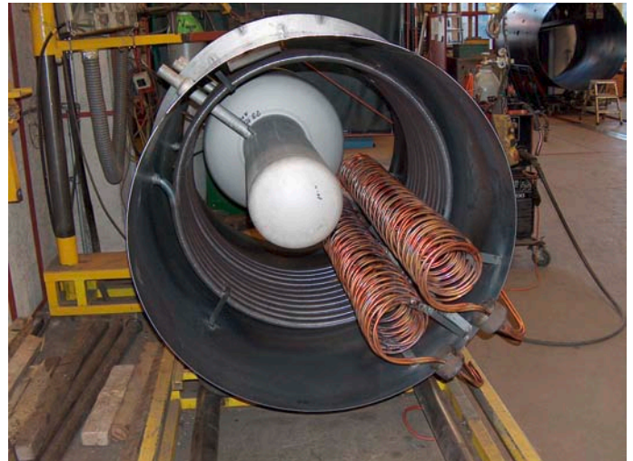
In der Produktion bei Jenni Energietechnik AG: Swiss Solartank® mit integrierten Kupferwärmetauschern und Warmwasser-Pilz.
